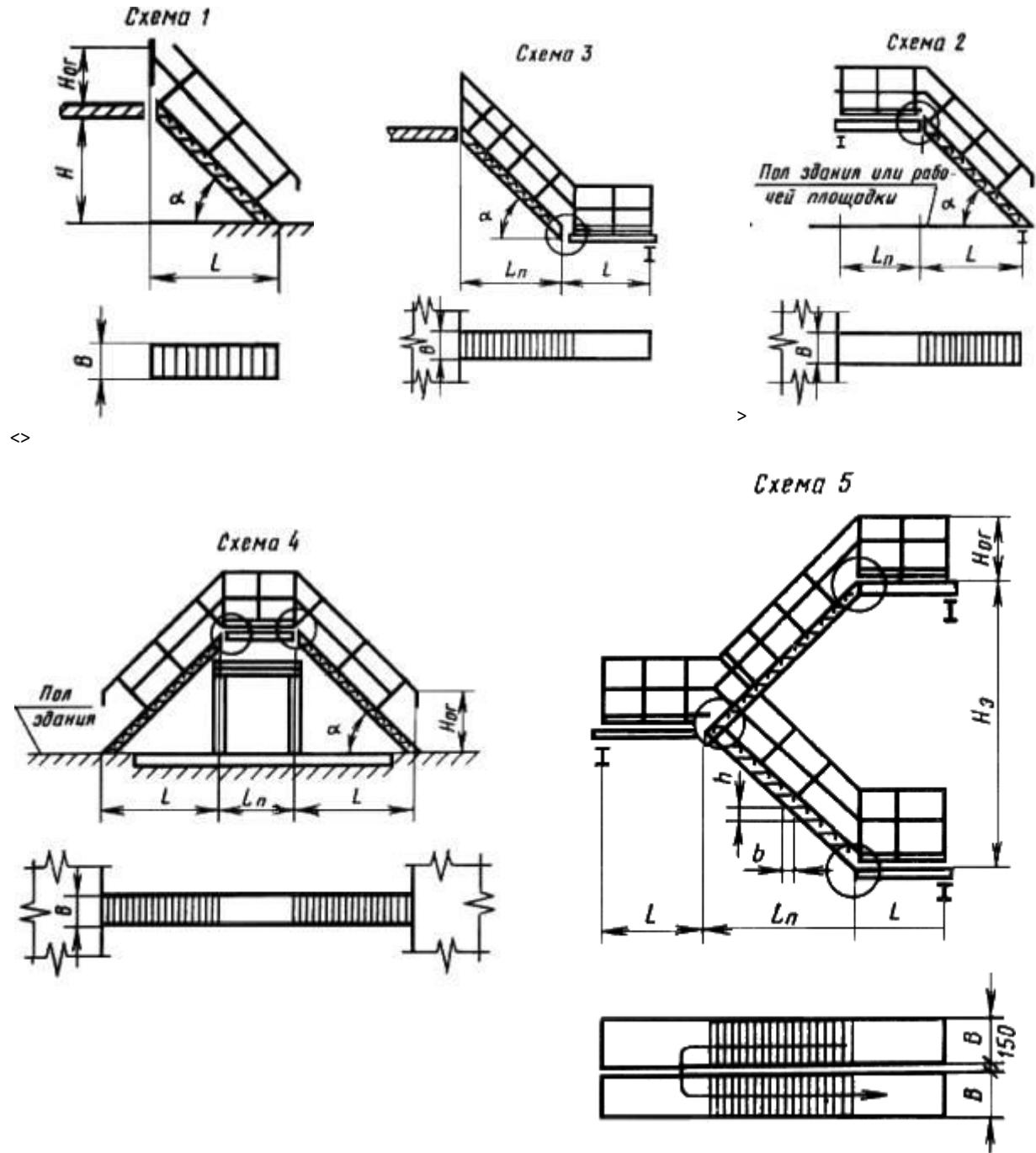
$H_3$  - высота этажа или расстояние между перекрытиями;  $H$ ,  $L$ ,  $B$ ,  $L_n$ ,  $H_{0r}$  - номинальные размеры элементов лестниц;  $\alpha$  - угол наклона лестниц;  $b$  - ширина ступени;  $h$  - высота ступени
