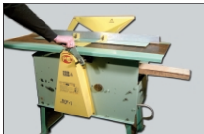
ПСР-1 – рейсмусование с механической подачей материала
