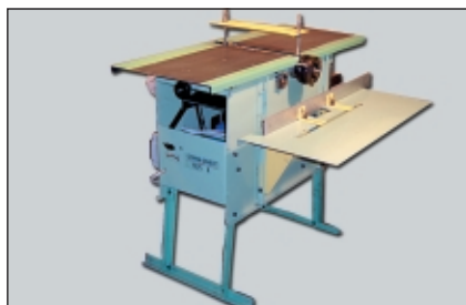
Положение для горизонтального фасонного фрезерования и сверления
