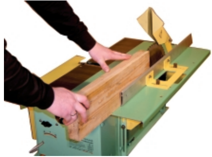
Пиление с регулировкой пропила в станках «СУПЕР» ДОС-280
