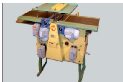
ПСР-А2 – двойное рейсмусование (на верхнем и нижнем столах) с автоматической подачей
