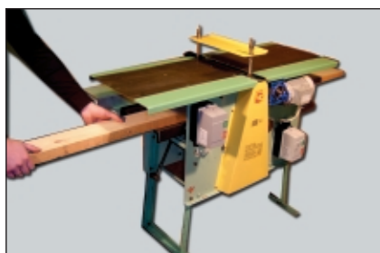
ПСР-А – рейсмусование на нижнем столе с автоматической подачей материала
