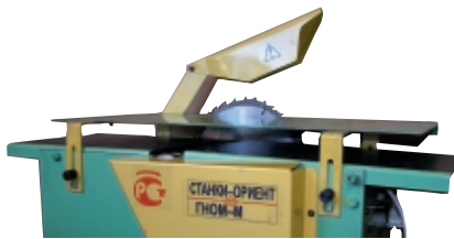
Зубр-МР в положении пиления с регулировкой глубины пропила
