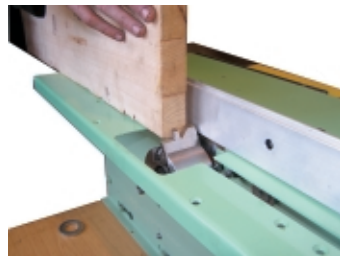
Горизонтальное фасонное фрезерование на всех станках
