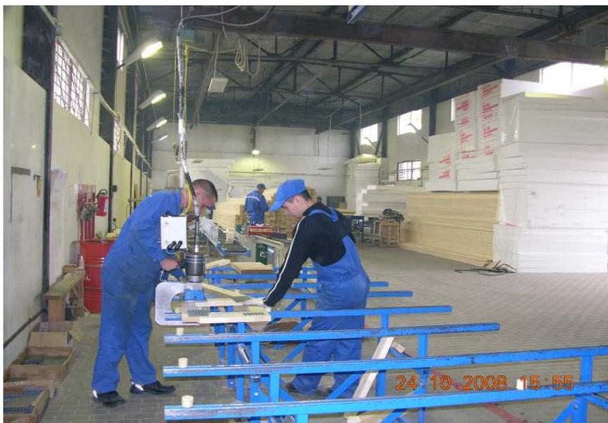
Линия по производству стропильных ферм представляет собой монтажные столы с фиксаторами для выставления шаблона будущей фермы и подвижный гидравлический пресс для фиксации узлов фермы при помощи металлических зубчатых пластин.
