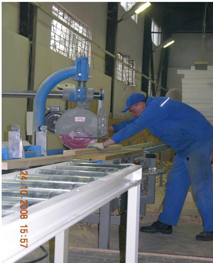
Подготовка компонентов будущей фермы (распил заготовок под необходимые размеры и углы) выполняется на прецизионной пиле с пневматической фиксацией поворотного круга с точностью линейных размеров - до 1мм и точностью запила углов - до 0,5 град.
